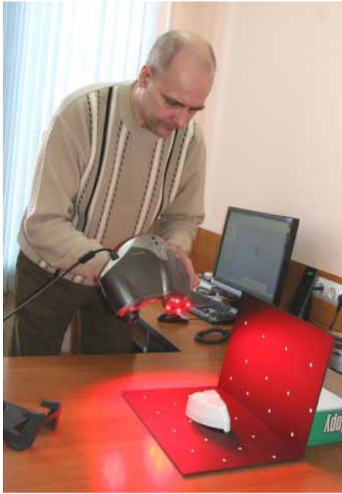
Так происходит трехмерное сканирование – в результате получаем компьютерную модель детали
